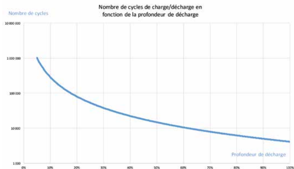
► FIGURE 43 : EVOLUTION DU NOMBRE DE CYCLES DE CHARGE/DÉCHARGE POUVANT ÊTRE EFFECTUÉS AVEC LES MEILLEURES BATTERIES DU MARCHÉ EN FONCTION DE LA PROFONDEUR DE DÉCHARGE, DONNÉES PUBLIQUES SAFT, ILLUSTRATION : FONDATION NICOLAS HULOT.
